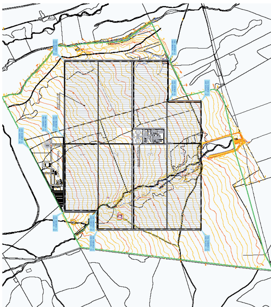
Figura 1. Plano en planta de la termosolar. Campo solar e isla de potencia.
