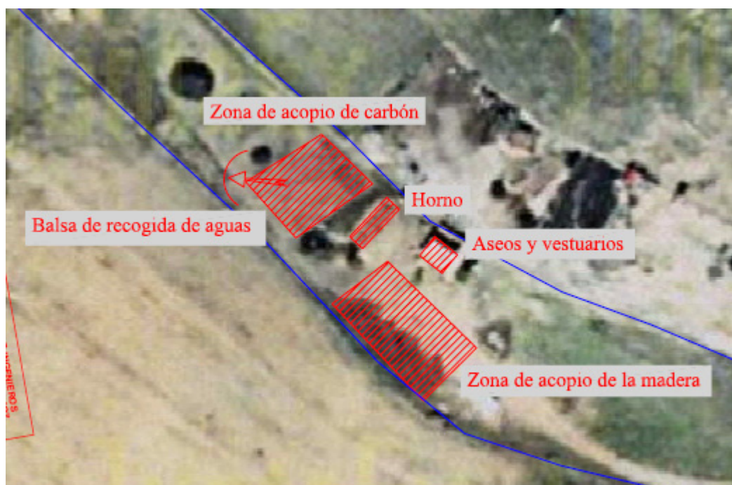
Figura 1 Plano en planta de la instalación.
