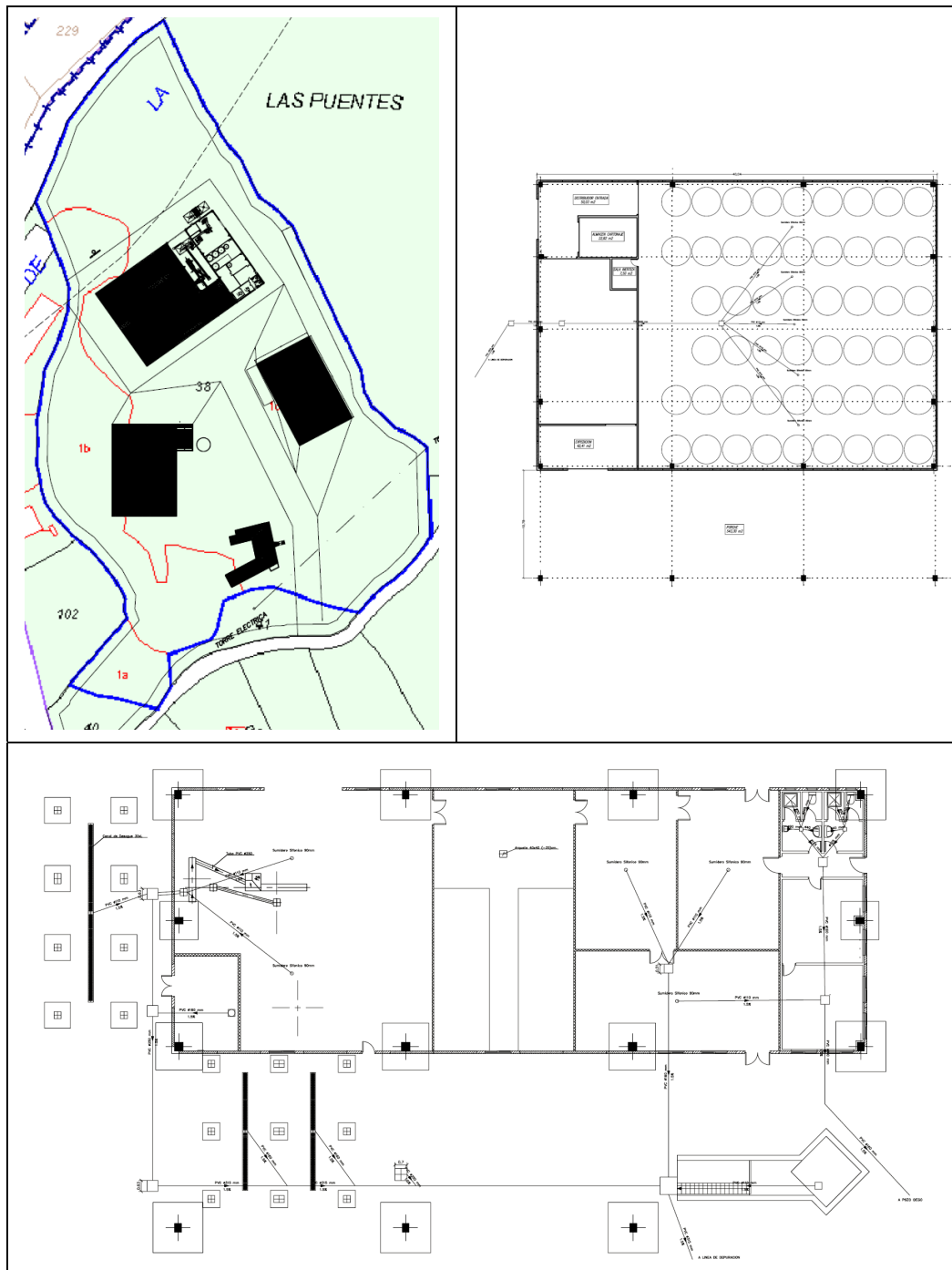
Figura 1. A la izquierda, arriba, plano en planta de las instalaciones en la parcela; a la derecha, arriba, saneamiento de la nave de depósitos y envasados; abajo, saneamiento de la nave de almazara.
