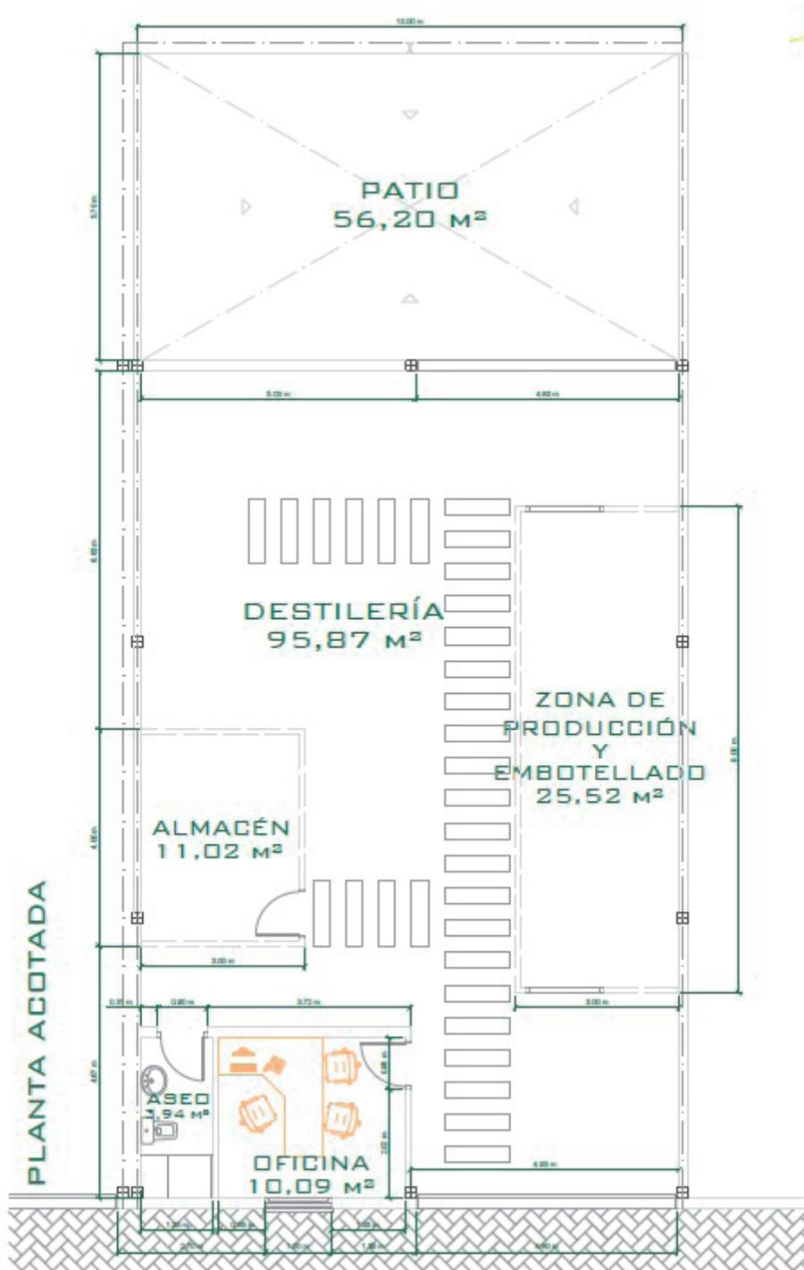
Fig. 1. Planta general de la instalación
