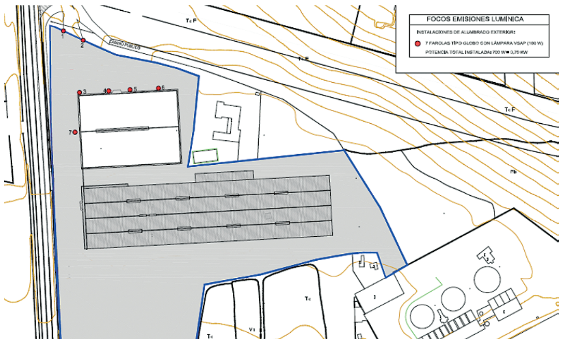
Figura 5. Plano luminarias exteriores
