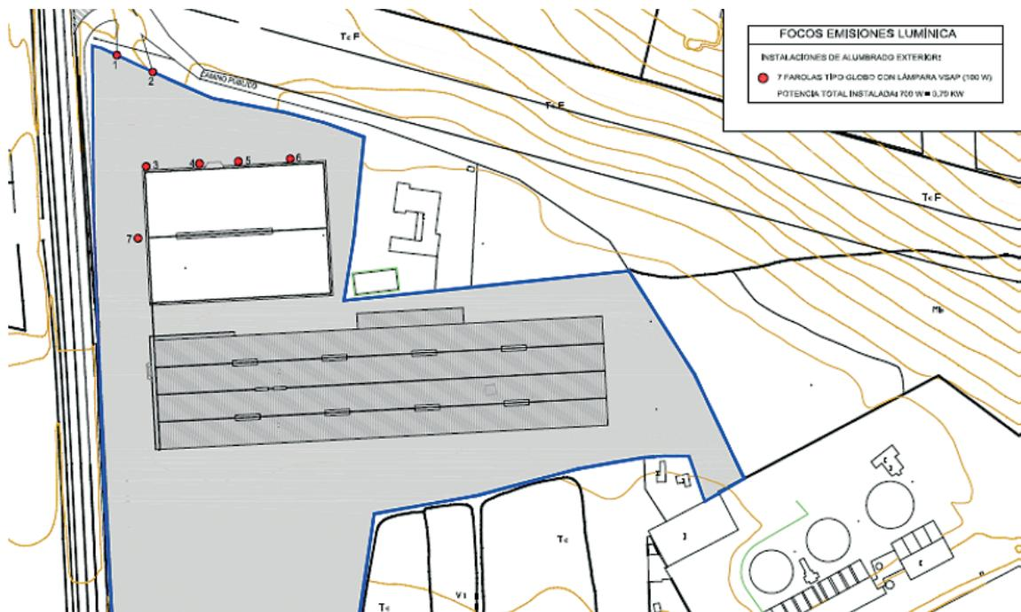
Figura 5. Plano luminarias exteriores
