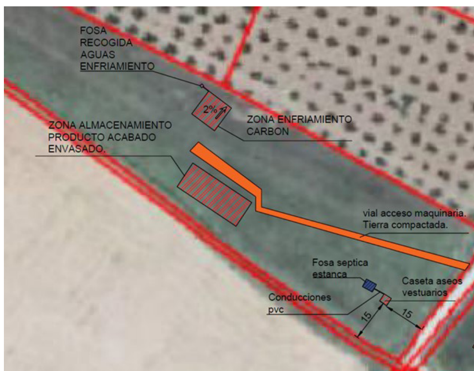
Figura 1. Plano en planta de las instalaciones
