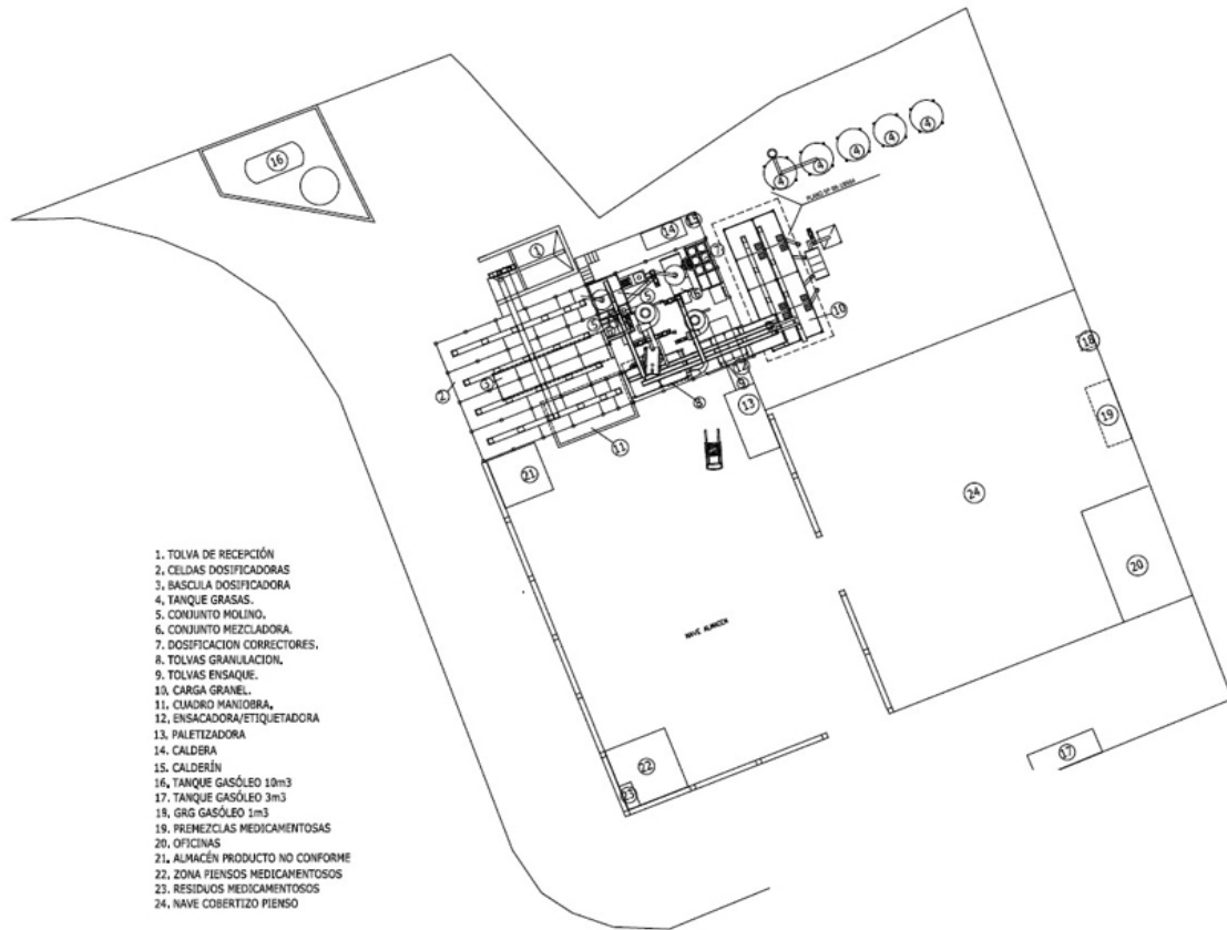
Fig. 1. Situación proyectada de las instalaciones.
