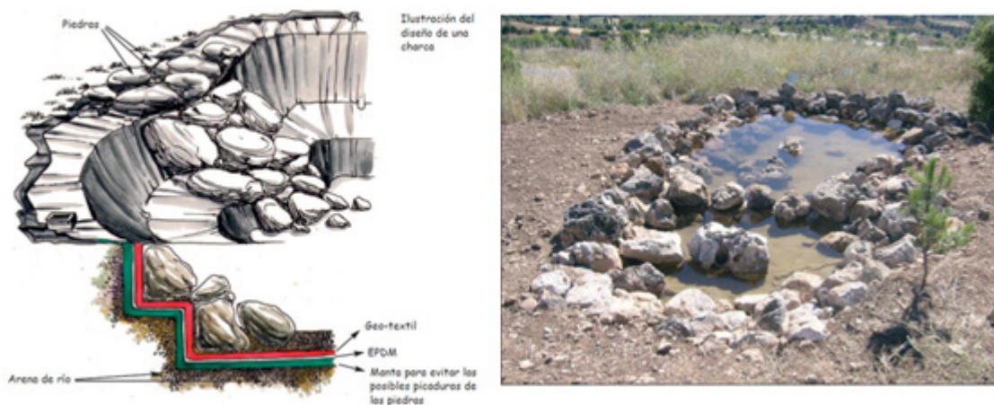
Imagen: imagen e ilustración del diseño de una charca adecuada como refugio para anfibios: (Fuente: https://reforesta.es/wpcontent/uploads/2020/05/charca )
