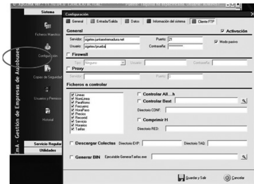
Fig. 1. Configuración de XPGema para transmisión de datos.
