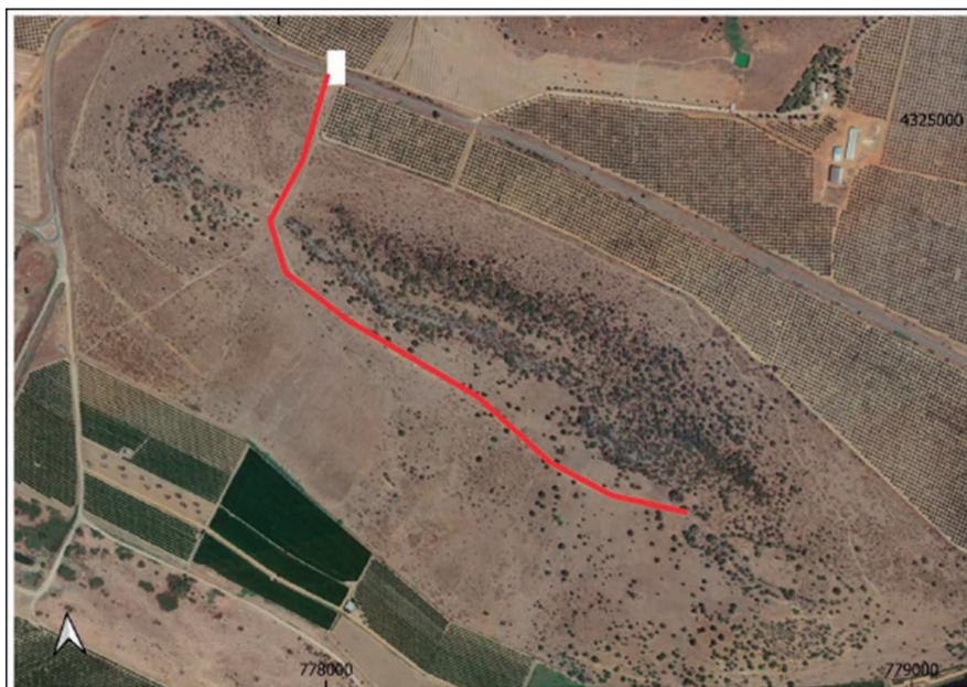
Mapa 2: Trazado alternativo para la conducción por camino existente y que evita la zona de cresta con mayor presencia de arbolado y afloramientos rocosos
