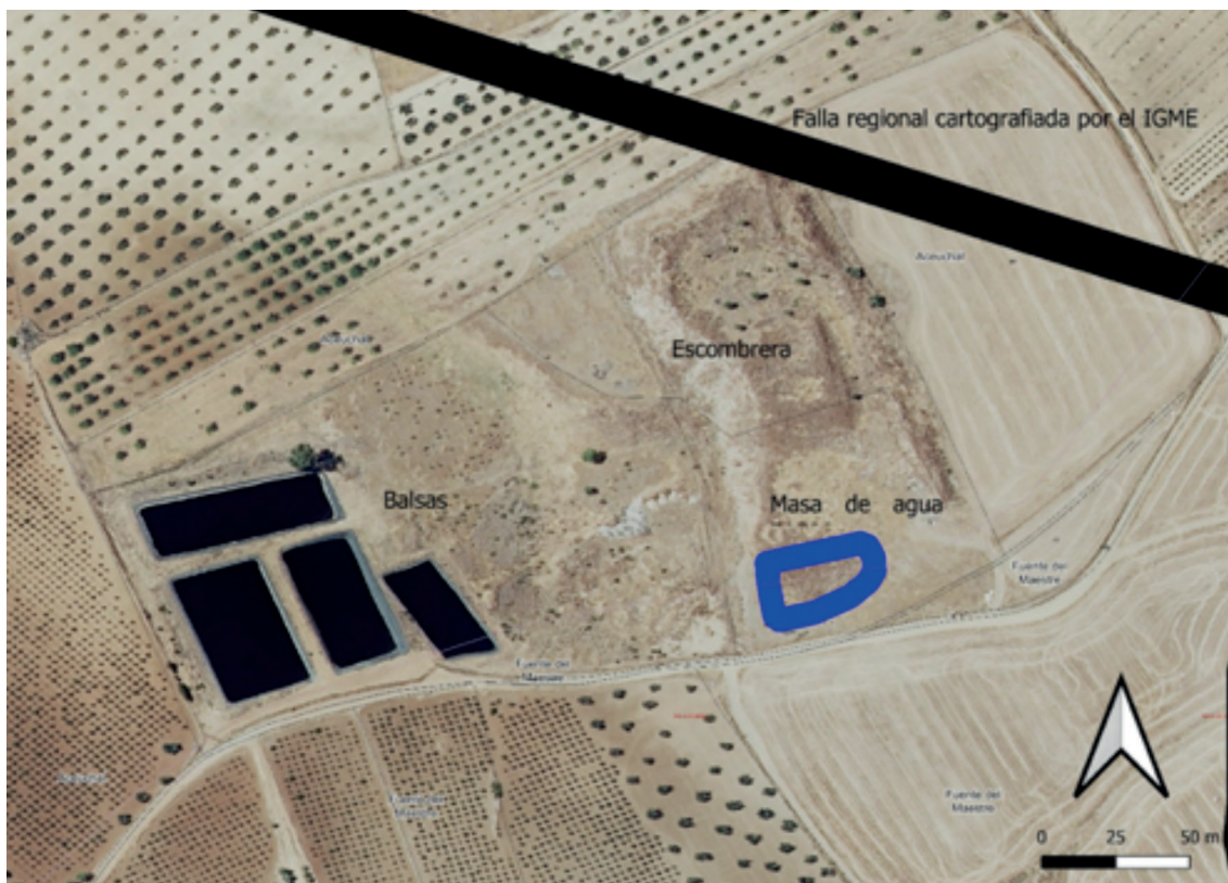
F2. Imagen de la ubicación de la parcela con las 4 balsas de evaporación con la cartografía hidrogeológica y geológica del IGME con la antigua masa de agua al norte de la parcela. Visualizado y exportados por el software QGIS.
