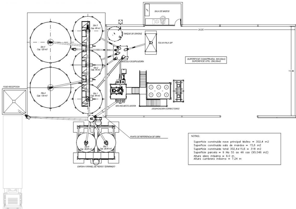
Fig.2. Planta general de distribución y maquinaria.
