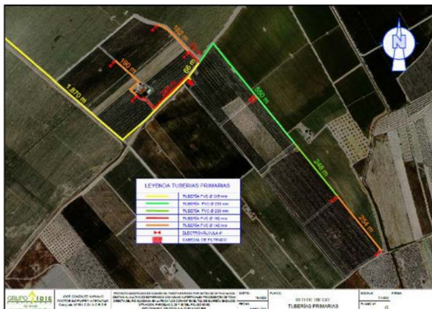
Red primaria (longitudes y diámetros) e infraestructuras
