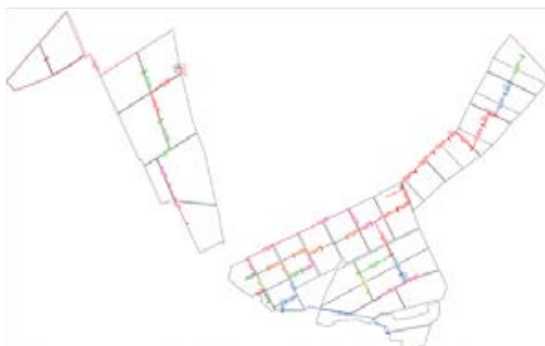
Plano 3. Red de tuberías primarias (Fuente: EsIA).
