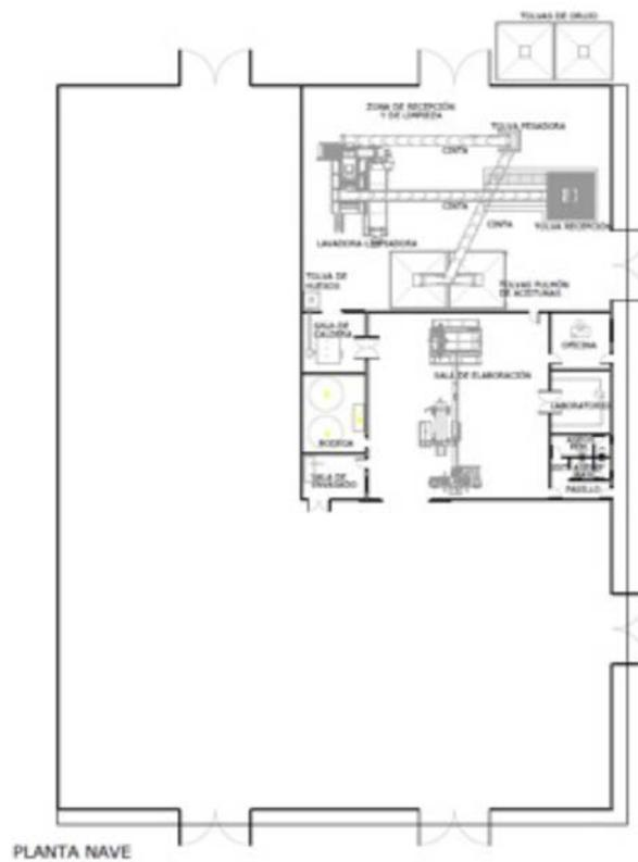
Fig. 3. Equipos Planta de almazara
