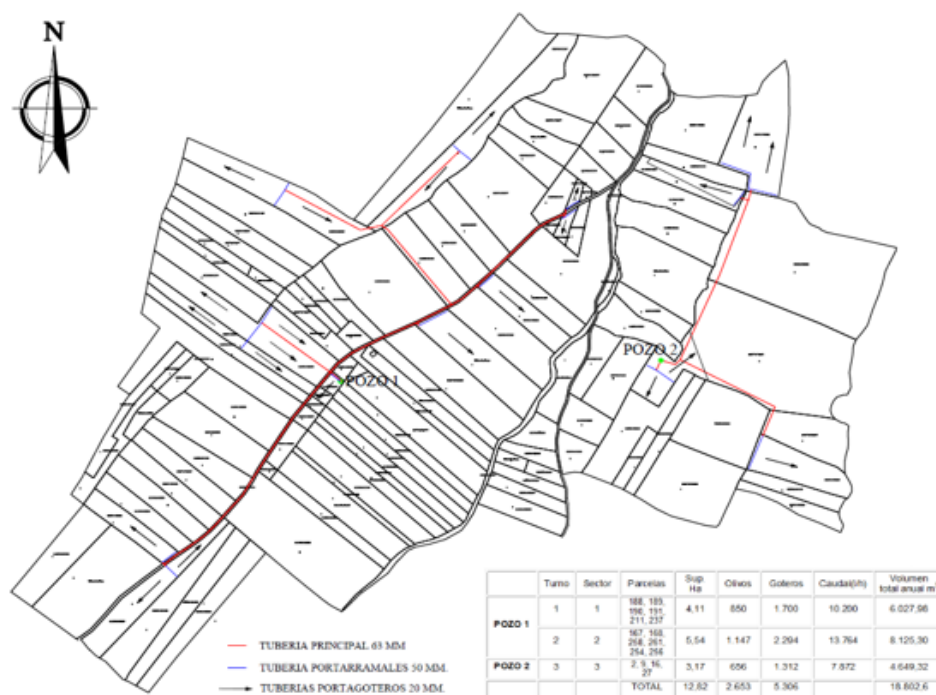
Plano 4. Distribución del sistema de riego. (Fuente: Documento Ambiental)
